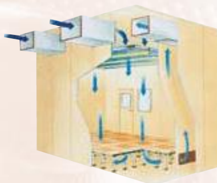
Down flow Cleanroom met open plenum, waarbij het plafond geheel bestaat uit absoluutfilters en voorzien is van lichtarmaturen. De vloer is geperforeerd.
