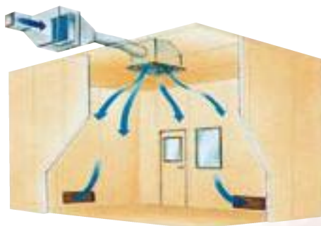
Turbulente Cleanroom waarbij het absoluutfilter centraal is geïntegreerd.
