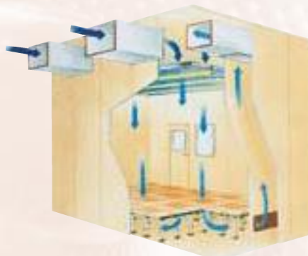
Down flow Cleanroom met open plenum, waarbij het plafond geheel bestaat uit absoluutfilters en voorzien is van lichtarmaturen. De vloer is geperforeerd.
