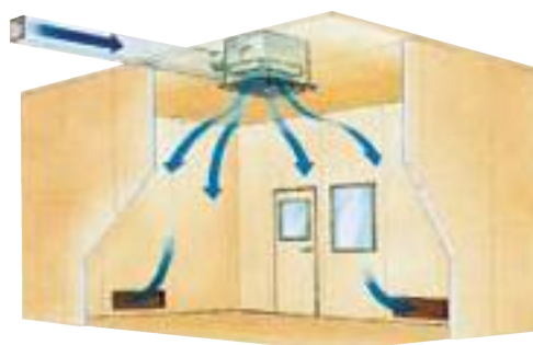
Turbulente Cleanroom waarbij een absoluutfilter in een plafond-module is gemonteerd.
